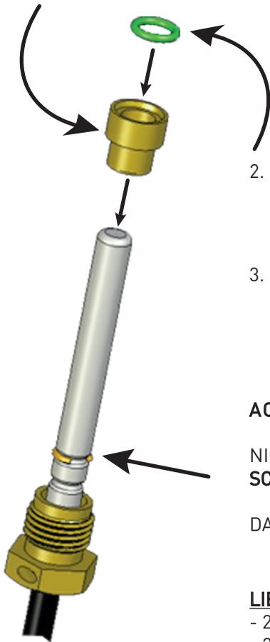
2. O-Ring (grün) bis in die Nut der Direktmessungshülse schieben.
